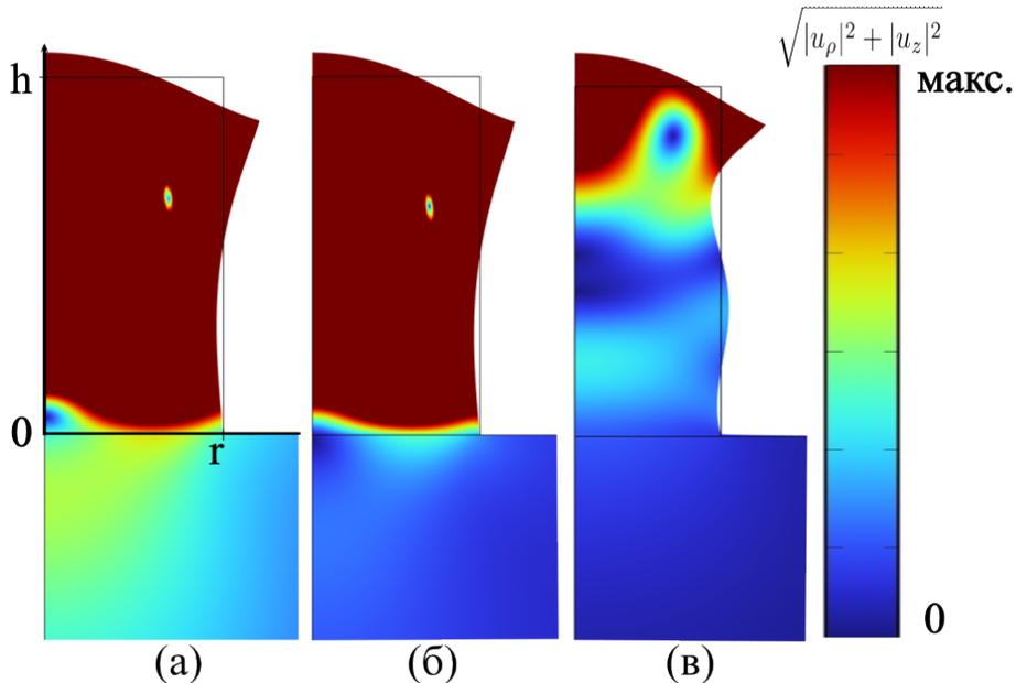
Рисунок 13 – На графике представлен модуль поля смещений для **б**-моды на рисунке 10. Графику (а) соответствует  $\eta = 1.10$ , графику (б) соответствует  $\eta = 1.05$ , графику (в) соответствует  $\eta = 0.40$
