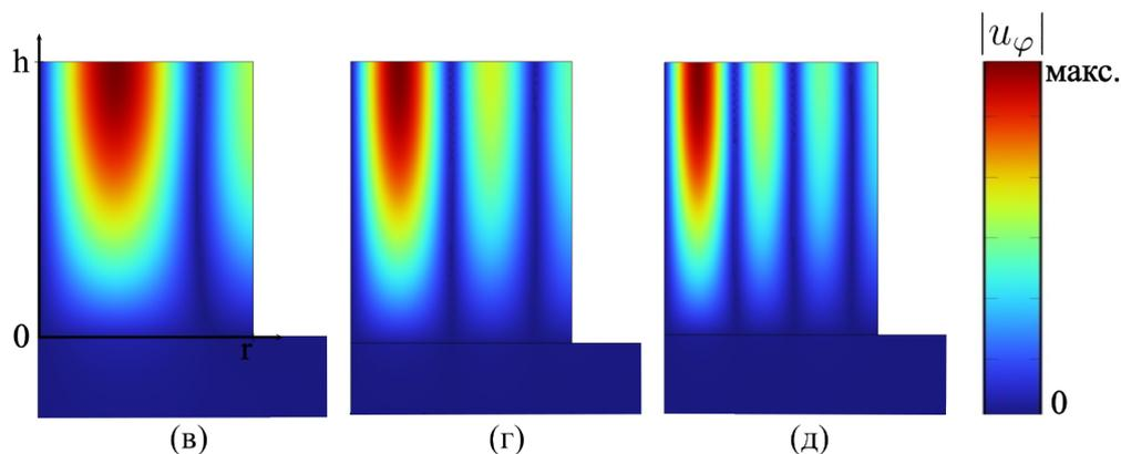
Рисунок 9 – На графике представлено поле модуля смещений для  $\phi$  - моды. Высота цилиндра  $h = 4$  м, радиус  $r = 3$  м. Графику (в) соответствует мода **в** на рисунке 7. Графику (г) соответствует мода **г** на рисунке 7. Графику (д) соответствует мода **д** на рисунке 7
