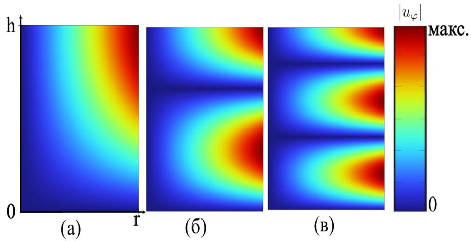
Рисунок 3 – На графике представлено поле модуля смещений для  $\phi$  - моды. Высота цилиндра  $h = 4$  м, радиус  $r = 3$  м. Аналитическое выражение для смещения и собственных частот (58). Графику (а) соответствует  $n = 0$ , графику (б)  $n = 1$ , графику (в)  $n = 2$
