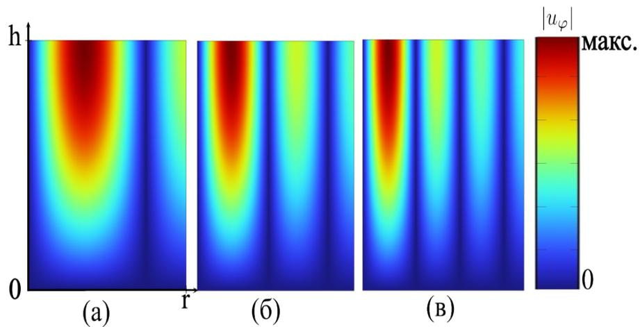
Рисунок 4 – На графике представлено поле модуля смещений для  $\phi$  - моды. Высота цилиндра  $h = 4$  м, радиус  $r = 3$  м. Аналитическое выражение для смещения и собственных частот (55). Графику (а) соответствует  $n = 0$  и  $\alpha_1$ , графику (б)  $n = 0$  и  $\alpha_2$ , графику (в)  $n = 0$  и  $\alpha_3$
