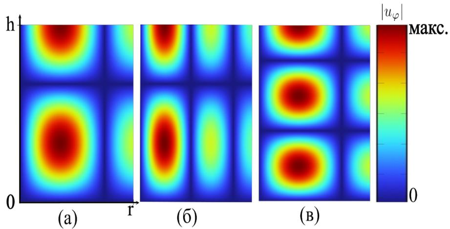
Рисунок 5 – На графике представлено поле модуля смещений для  $\phi$  - моды. Высота цилиндра  $h = 4$  м, радиус  $r = 3$  м. Аналитическое выражение для смещения и собственных частот 55. Графику (а) соответствует  $n = 1$  и  $\alpha_1$ , графику (б)  $n = 1$  и  $\alpha_2$ , графику (в)  $n = 2$  и  $\alpha_1$
