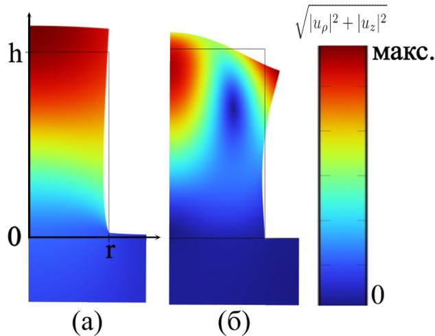
Рисунок 11 – На графике представлено поле модуля смещений для  $\rho z$  - моды и вид деформации. Высота цилиндра  $h = 4$  м, радиус  $r = 3$  м. Графику (а) соответствует мода **а** на рисунке 10. Графику (б) соответствует мода **б** на рисунке 10
