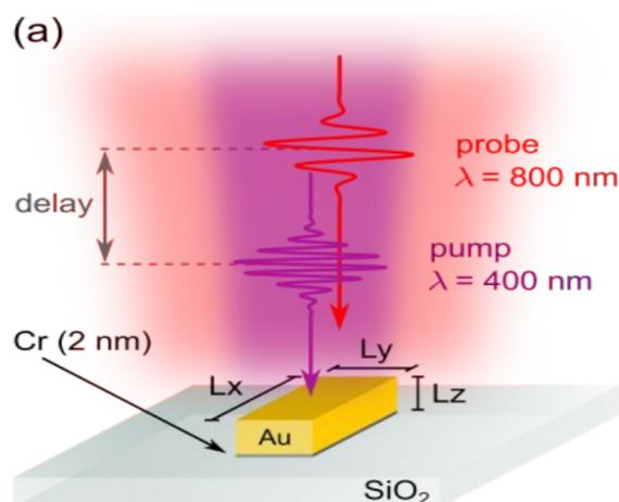
Рисунок 1 – Пример из [5] возбуждения механических колебаний посредством лазерных импульсов, передающих энергию плазмонной наночастице
